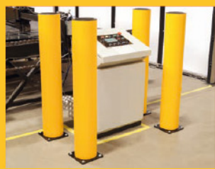
Poteaux protégeant un pupitre de commande pour une machine dans un centre de production.
