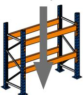
Plus le nombre de travées (charge par travée) est bas, plus la capacité de charge est réduite. Veuillez prendre en compte la variation en pourcentages des capacités de charge diminuées (voir les dessins à droite).
