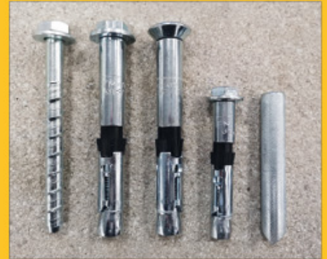
Verschillende bouten op maat van de boomhoogtes.
