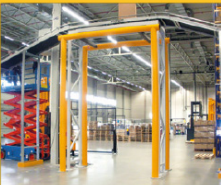
Op maat gemaakte hoogte bescherming voor loopbruggen en transportbanden.
